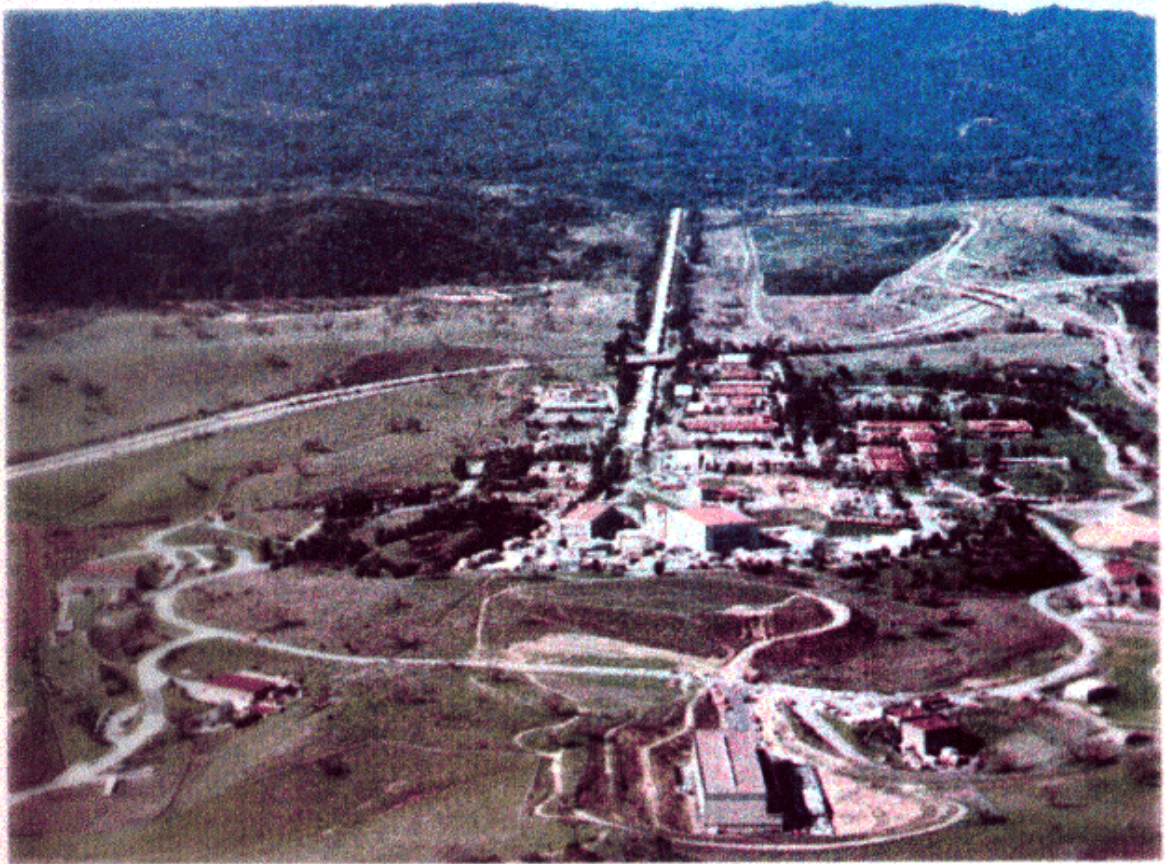
4.16 Dieses Luftbild zeigt das Linearbeschleunigerzentrum in Stanford (SLAC). Der drei Kilometer lange Linearbeschleuniger wurde unter einer Autobahn hindurchgeführt. Die Versuche finden am Kopf des Beschleunigers (Vordergrund) und in einem unterirdischen Speicherring statt.
